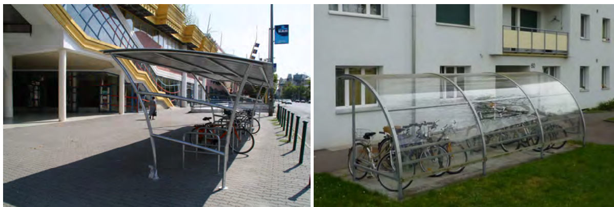
Ukázky přístřešků, vlevo kryjící stojany u nákupního centra (Budapešť), vpravo v rezidenční čtvrti řešen včetně závětrí (Bern)
